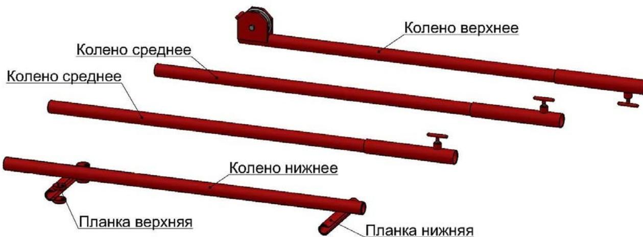
Рис. 8. Кран-подъёмник.
