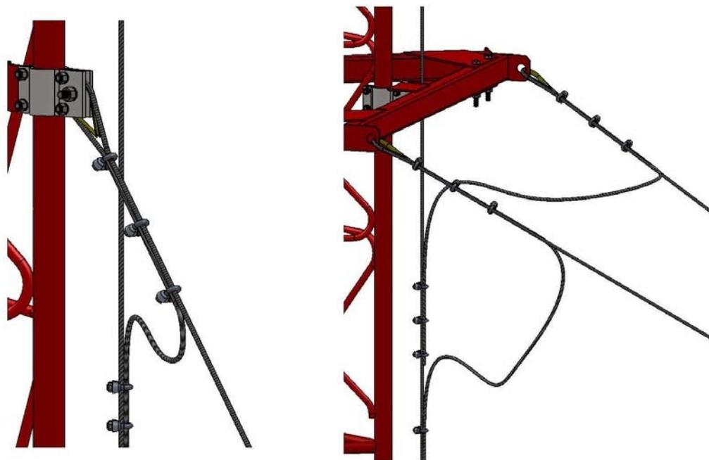
Рис. 26. Соединение оттяжек с токоотводом.
