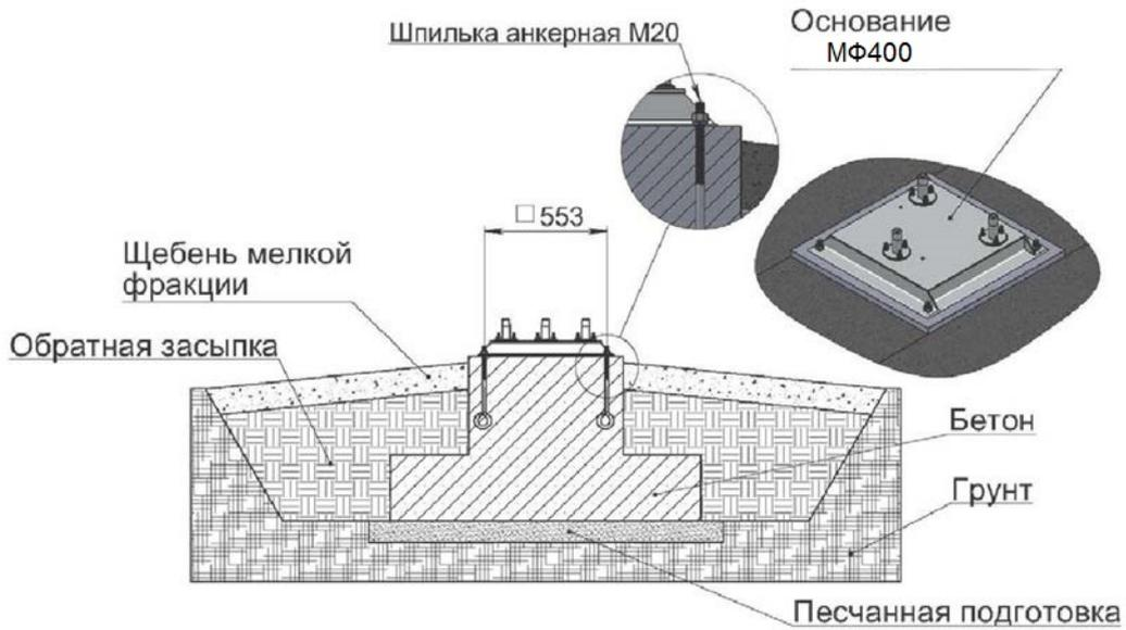
Рис. 1. Установка основания МФ-400 и фундамент.
